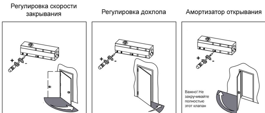
**ВНИМАНИЕ:** не выкручивайте винты из корпуса доводчика, так как это создает угрозу разгерметизации и утечки масла
